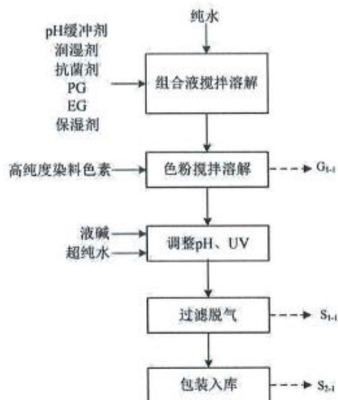
图1 数码喷印活性墨水生产工艺流程示意图
